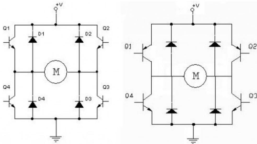
U oba slučaja potrebno je dodati diode jer motor ima svojstvo induktiviteta i nakon što prestane kroz njega teći struja on postaje izvor struje koja bi potekla prema mikrokontroleru/Arduinu i uništila ga, te diode služe kao osigurači koji sprječavaju tu struju da dođe do Arduina.
